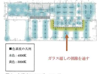
図6 色温度によるゾーニング Fig.6 Zoning by the light color temperature.
