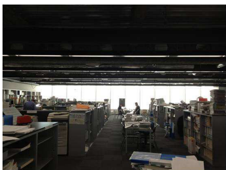
図 6.10 窓面輝度と室内輝度の対比が激しいケース
