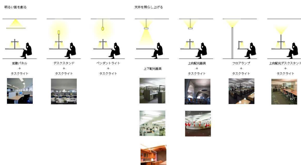
図 7.1 タスクアンドアンビエント照明方式のパターン
