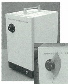
図 2.1.2-14 屋外用小型近赤外分光装置 13)14)
