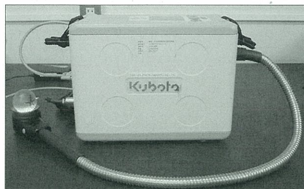
図 3.1.4-2 トマト品質の非破壊計測（可視・近赤外分光光度計はクボタ製フルーツセレクタ K-BA100R の波長拡張型）
