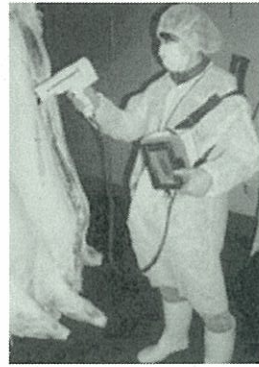
図 2.1.2-12 小型近赤外分光装置による現場での食肉測定(上)、魚肉測定(下)
