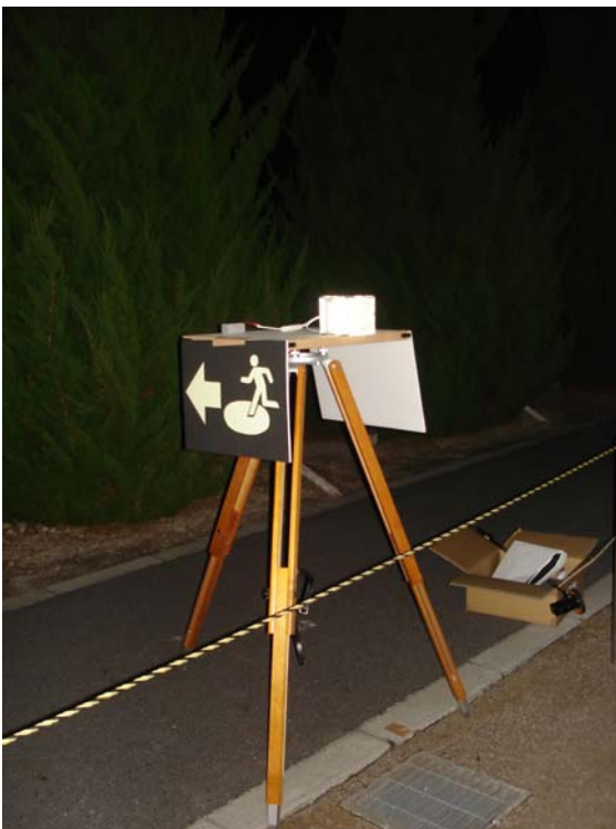
図 5.4.4 誘導標識の設置方法
