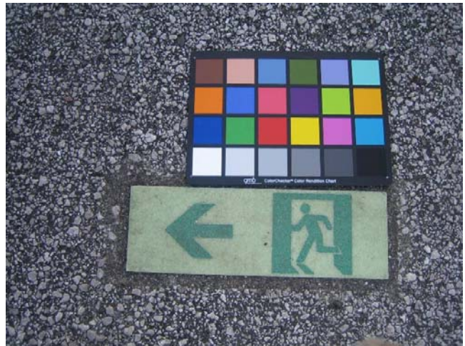
C-3 蓄光型誘導標識
