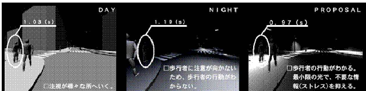
図 6.5.5-3 昼間 / 夜間 / 夜間提案における歩行者認知時間の測定結果
