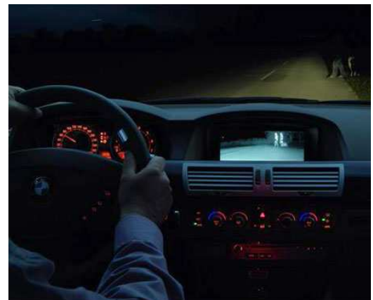
図 4.2.7-2 引用文献38)で安全装置の一例として紹介されているナイトビジョンシステム。フロントガラスの視野からは前方の人影は分かりにくいですが、ダッシュボードに取り付けられた小画面には、赤外線カメラによって捉えられた歩行者が白い影として映し出されている。
