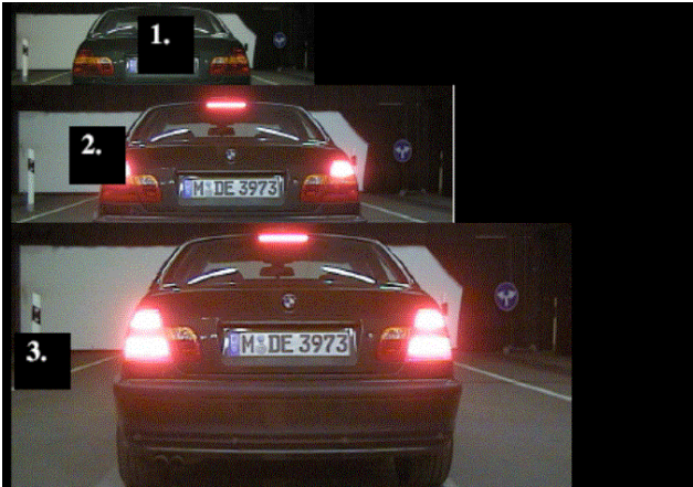
図 6.4.2-1 Emergency Signal Lamp 例
