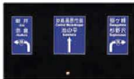
図 6.3.1-1 高輝度反射シート
