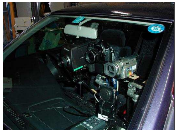
図 3.3.2-4 交差点における画像撮影の計測
