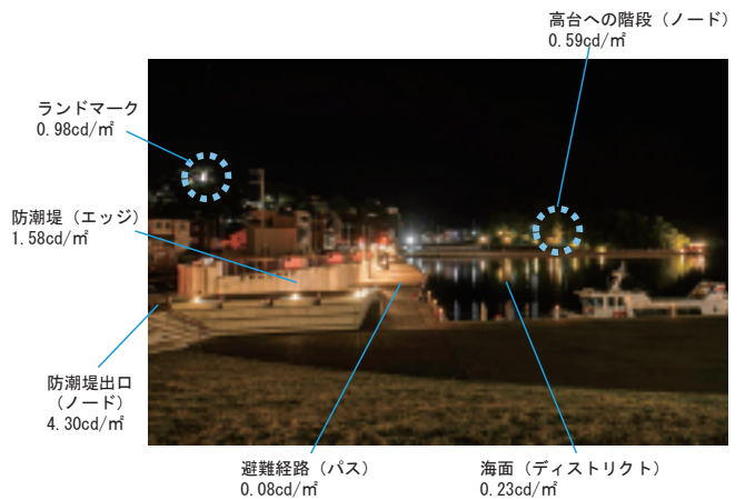
図4 気仙沼市内湾地区における景観構成要素の輝度レベル Fig.4 Luminance levels of components in Kesenuma City bay area.
